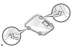
(d) Engage the 4 claws to install the No. 1 room light lens.
